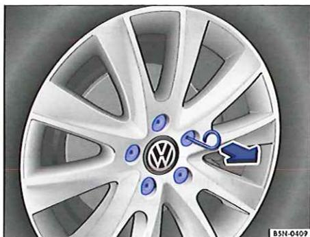
Fig. 239 Retrait des capuchons des boulons de roue.
