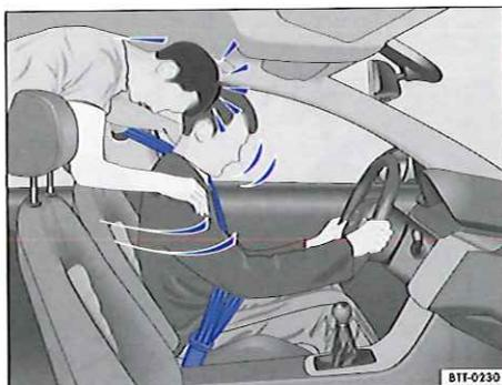
**Fig. 65** Le passager arrière non sanglé est projeté en avant et vient heurter le conducteur sanglé.
