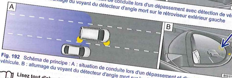
Fig. 192 Schéma de principe : A : situation de conduite lors d'un dépassement et d'un rabattement du véhicule. B : allumage du voyant du détecteur d'angle mort sur le rétroviseur extérieur droit
