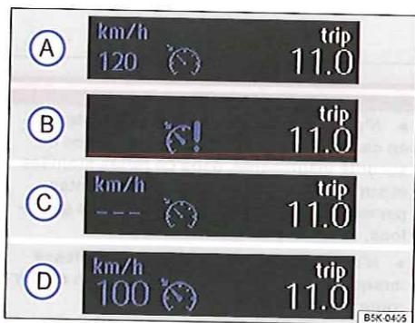
Fig. 169 Sur l'écran du combiné d'instruments : indications sur l'état du régulateur de vitesse
