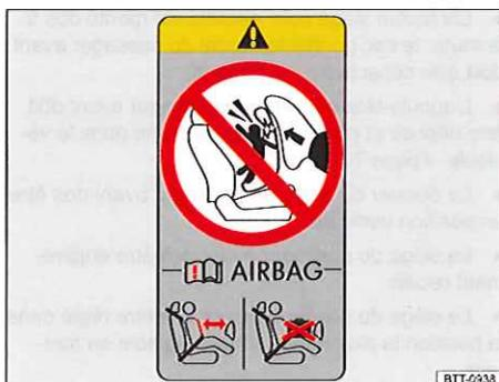
Fig. 81 Sur le montant B côté passager avant : autocollant de sac gonflable
