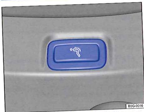
Fig. 57 Dans la zone inférieure du siège du conducteur : touche de la fonction de massage dorsal
