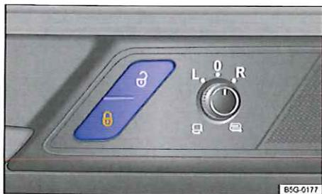
Fig. 29 Dans la porte du conducteur : touche de verrouillage centralisé.
