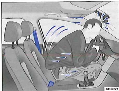
**Fig. 64** Le conducteur non sanglé est projeté en avant.
