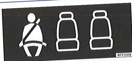
Fig. 61 Indicateur de statut des ceintures pour les places arrière dans le combiné d'instruments.
