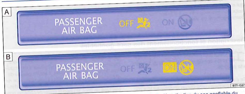
Fig. 72 Dans la partie supérieure de la console centrale : témoin de désactivation du sac gonflable du passager avant
