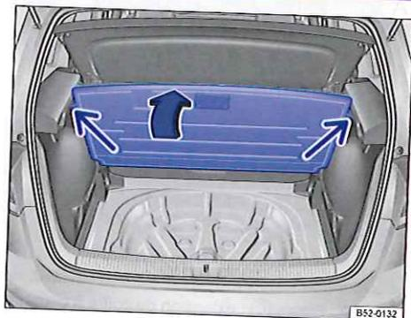
Fig. 108 Dans le coffre à bagages : plancher modulable de coffre à bagages relevé
