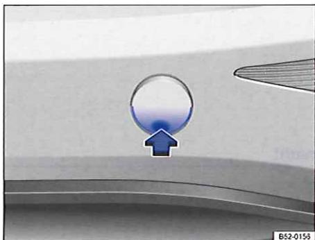
**Fig. 269** Dans le pare-chocs arrière droit : retrait du cache
