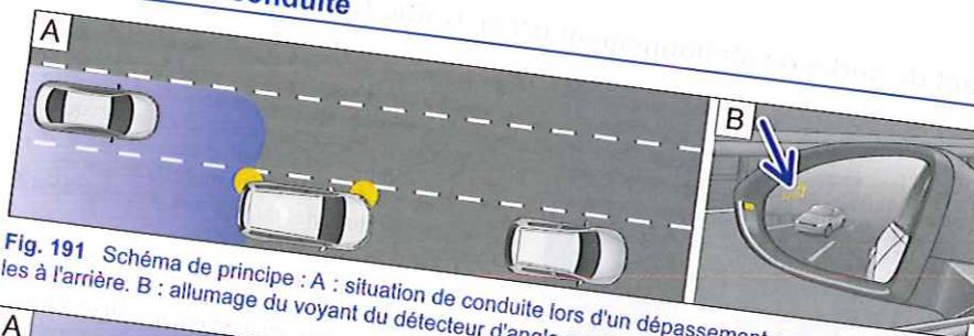
Fig. 191 Schéma de principe : A : situation de conduite lors d'un dépassement avec détection de véhicules à l'arrière. B : allumage du voyant du détecteur d'angle mort sur le rétroviseur extérieur gauche
