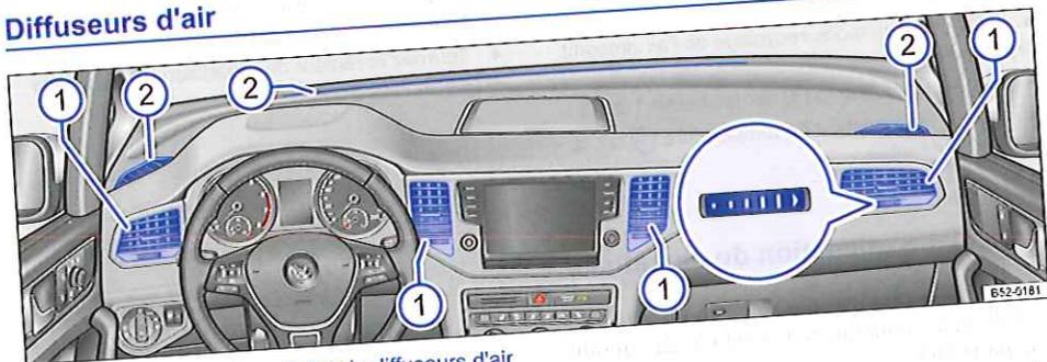
Fig. 200 Dans le tableau de bord : diffuseurs d'air
