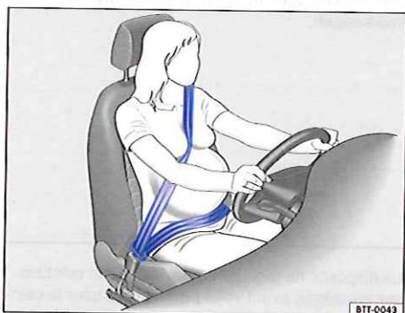
Fig. 70 Ajustement correct de la sangle recommandé pour les femmes enceintes
