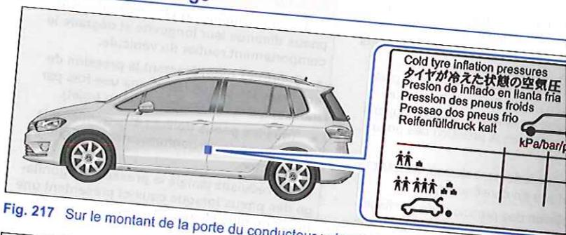
Fig. 217 Sur le montant de la porte du conducteur : plaque de pression de gonflage des pneus
