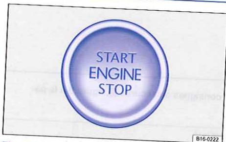
Fig. 138 Dans la partie inférieure de la console centrale : bouton de démarrage du système de fermeture et de démarrage Keyless Access
