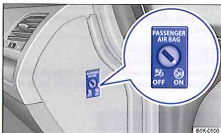
**Fig. 75** Dans la boîte à gants : commande à clé de désactivation et d'activation du sac gonflable frontal du passager avant.
