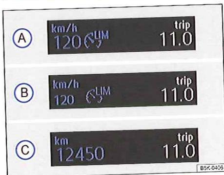
Fig. 172 Sur l'afficheur du combiné d'instruments : indications sur l'état du limiteur de vitesse
